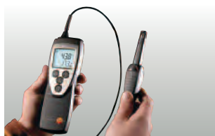
Vochtvoelerskop op de handgreep met voelersleiding, bijvoorbeeld voor het controleren van het opslagklimaat
